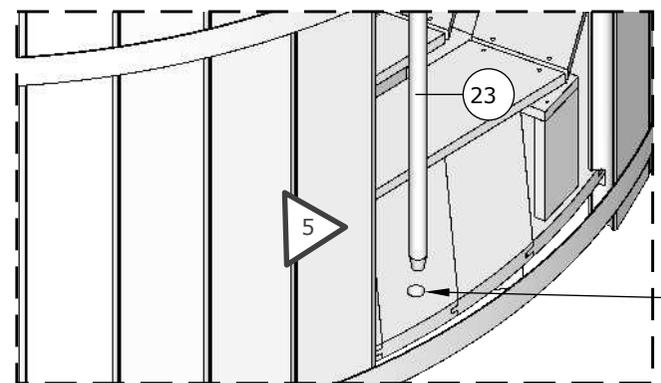
Bohren Löcher Ø 25 mm.
