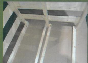
Nun wird der hintere, obere Pfosten (1790x95x28 mm) oben an den Eckpfosten mit je 2 Schrauben (4x45 mm) befestigt. Das Gleiche machen Sie mit dem vorderen, oberen Pfosten (1790x45x28 mm) an der Vorderseite des Kaminholzregals.
